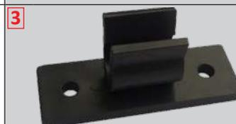
Clips de ensamble de bulbo. Plástico PA66, ensamble mediante 2 tornillos o adhesivo, para bulbos de diámetro 8 mm, temperatura máxima de 80°C.
