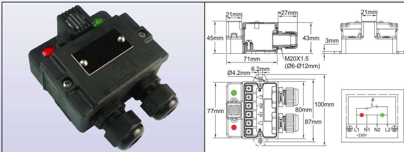
En estas cajas, el termostato, tipo disco bimetálico, está sobremoldeado y está aislado térmicamente de la pared en la que está montado. Su copa de detección de temperatura está protegida mecánicamente por una rejilla. Se encuentra en la parte delantera de la carcasa para estar en una zona de circulación natural de aire.
