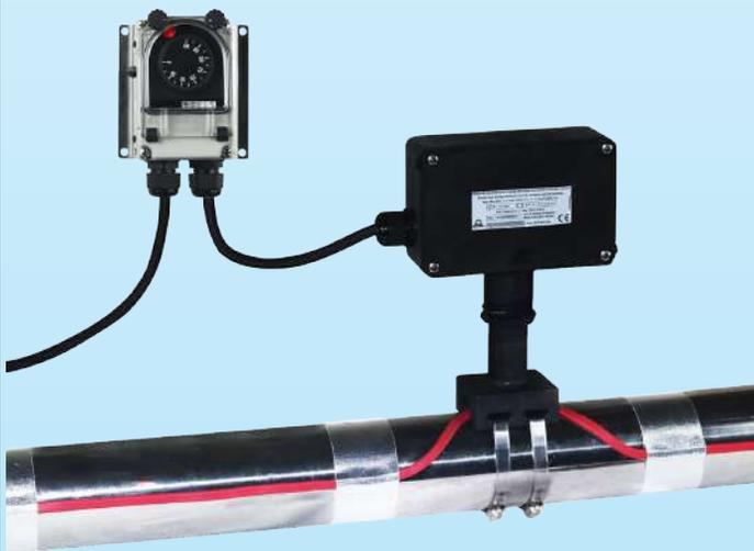
Ejemplo de ensamble en dos cables calefactores de control del calor, con la caja de distribución Y26 con soporte elevado de acero inoxidable, para protección contra heladas de tuberías.
